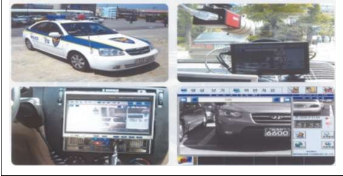
شكل 25 : جهاز داخل سيارة الشرطة لمراقبة السيارات على الطرق
