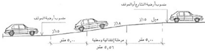
الشكل (21) يوضح قطاع رأسي لمنحدر مستقيم و مراحلہ الانتقالية و الوسطية
