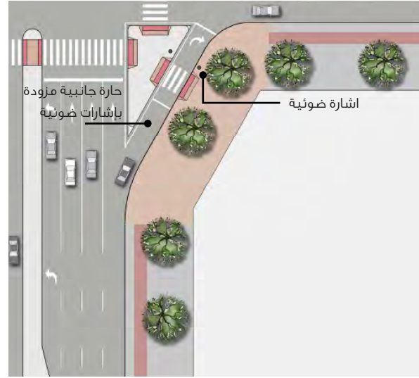
الشكل رقم (15.6) : الخيار الرابع : حارة جانبية للدوران يميناً مزودة بإشارات ضوئية
