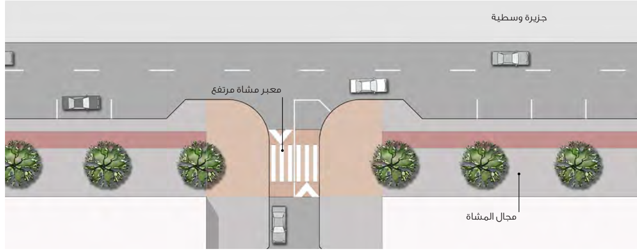
الشكل رقم (17.5) : مسار الدراجات الهوائية خلال تقاطعات الطرق الصغرى
