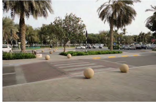
تهدئة السرعة باستخدام المعابر المرتفعة ، أبوظبي
