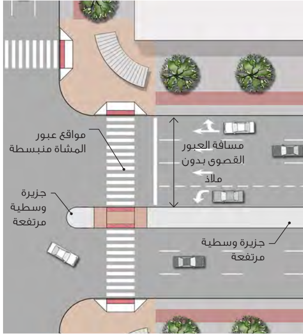
الشكل رقم (10.5) : العناصر النموذجية لمعبر المشاة
