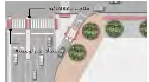
الشكل رقم (10.6) : ملجأ للمشاة عند الحارات المنعطفة يساراً
