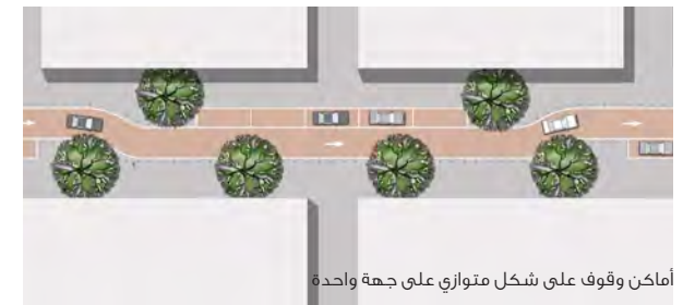
الشكل رقم (5.5) : موقف سيارات مستخدم في تهدئة حركة المرور
