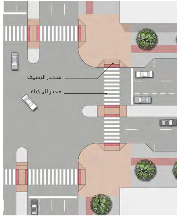
الشكل رقم (9.6) : تراسف المنحدرات ومعابر المشاة عند التقاطعات
