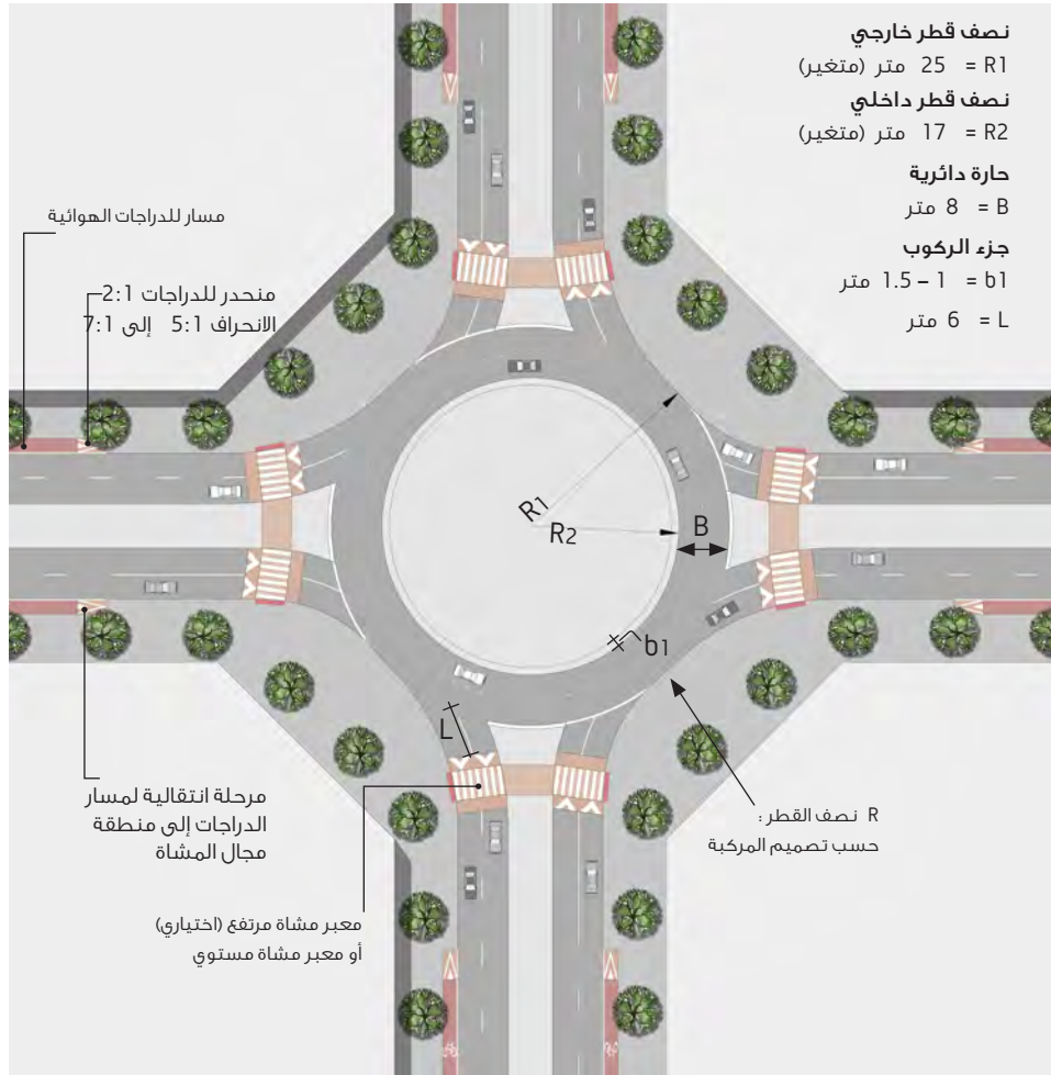
الشكل رقم (20.6) : التصميم لدوار ذي حارتين
