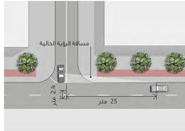
الشكل رقم (2.6) : متطلبات مسافة الرؤية
