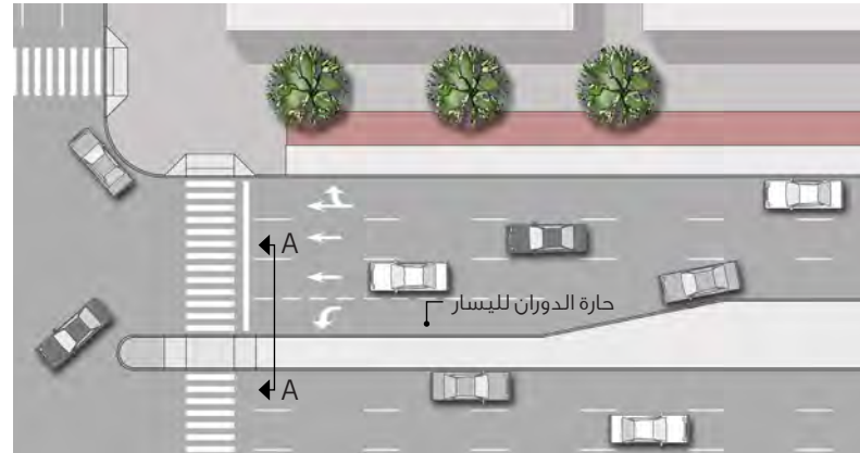
الشكل رقم (25.5) : خطة الدوران إلى اليسار عند الجزيرة الوسطية مع توضيح المقاطع العرضية
