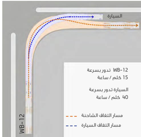
الشكل رقم (3.6) : الزوايا المصممة للشاحنات
