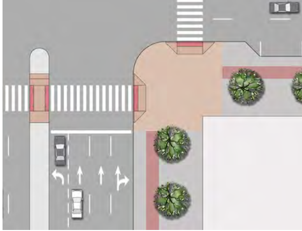
الشكل رقم (11.6) : الخيار الأول : عدم وجود حارة مخصصة للدوران يميناً
