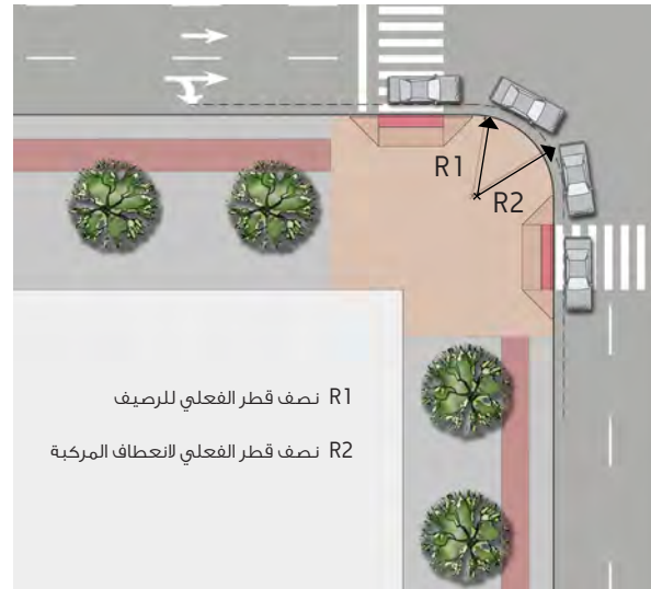
الشكل رقم (4.6) : نصف قطر الدوران الفعلي مقابل نصف القطر الفعال
